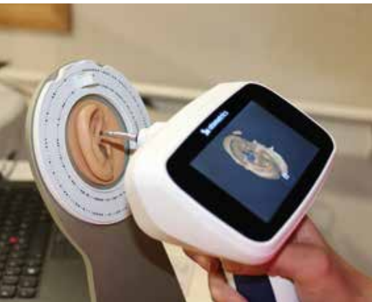
Con la scansione 3D del condotto uditivo, la produzione di auricolari personalizzati per gli apparecchi acustici diventa completamente digitale
