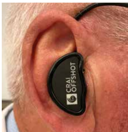
L'otoprotettore su misura Off-Shot si attiva solo nel momento dello sparo.
