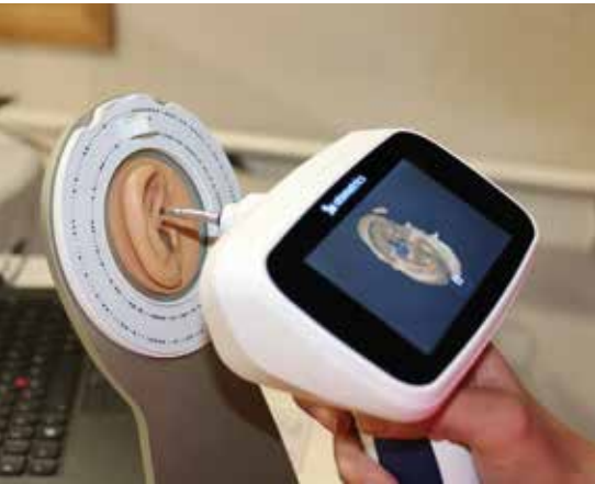
Der 3D-Scanner kommt bei der komplett digitalen Fertigung maßgefertigter Ohrpassstücke zum Einsatz
