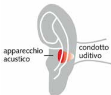
Gli apparecchi endoauricolari vengono inseriti nel canale uditivo.
